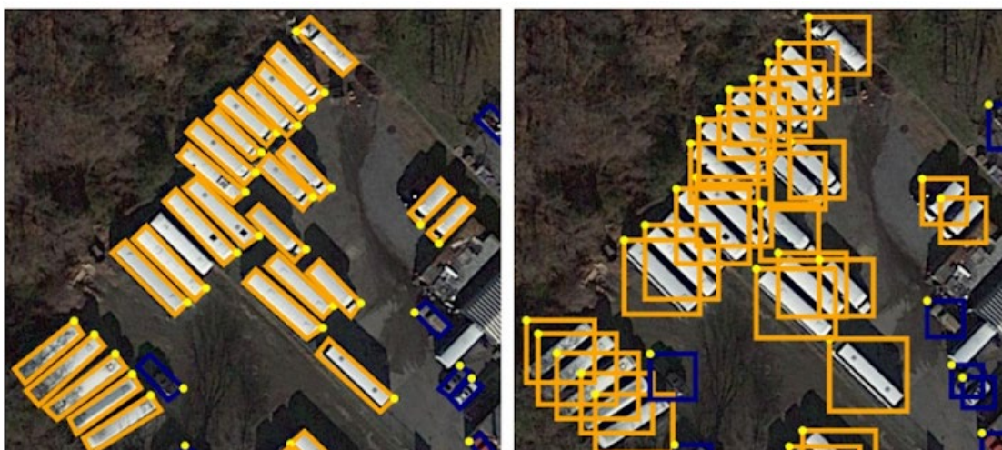
Figura 1-1: Esempi di bounding box: Oriented BB (sinistra) e Horizontal BB (destra)
