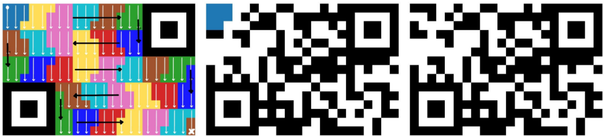
Figura 4: A) Tassellatura a serpentina, B) Disposizione stringa codificata, C) Aggiunta bit metraggio
