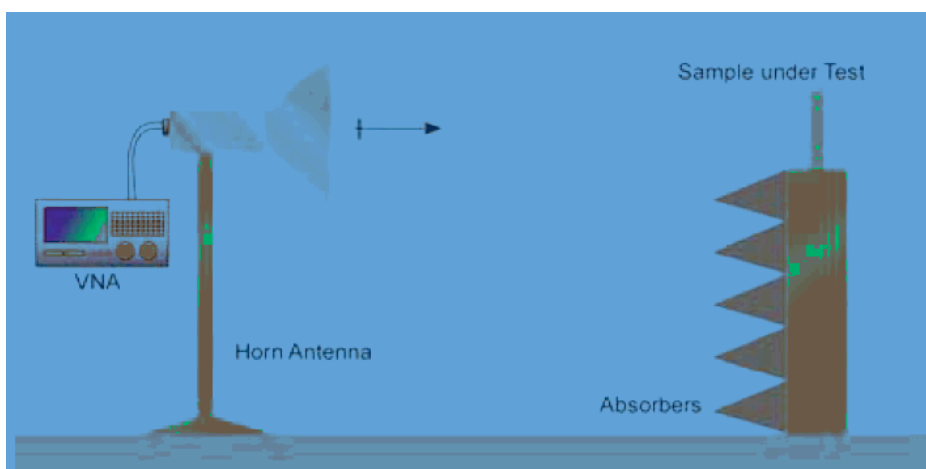
Fig. 3.1: banco di misura per la raccolta dei dati in ambiente reale
