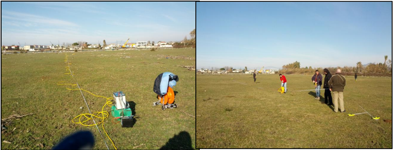
Figura 10. Alcune immagini relative alla stesa dei profili geoelettrici.
