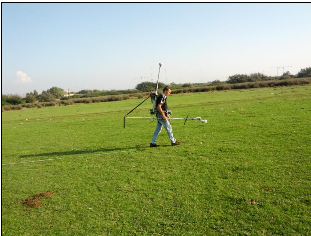
Figura 12. Fase d'acquisizione dati mediante il magnetometro ai vapori di cesio G-858 in configurazione gradiometrica.
