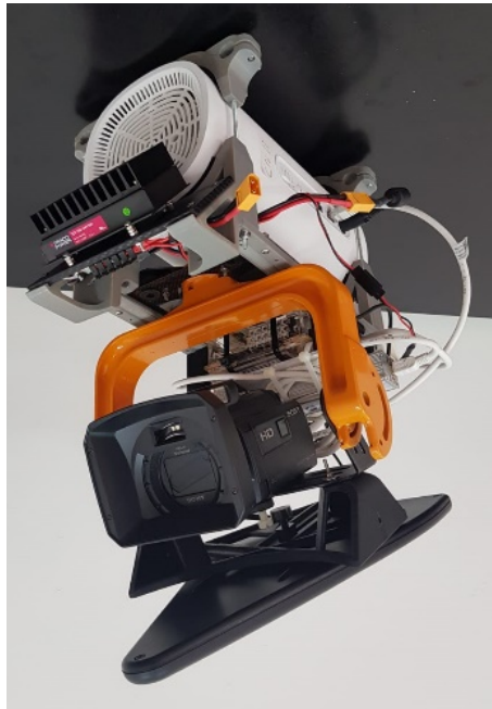
Figura 20: Payload che integra gli scenari "sicurezza" e "rilievo di jammer"
