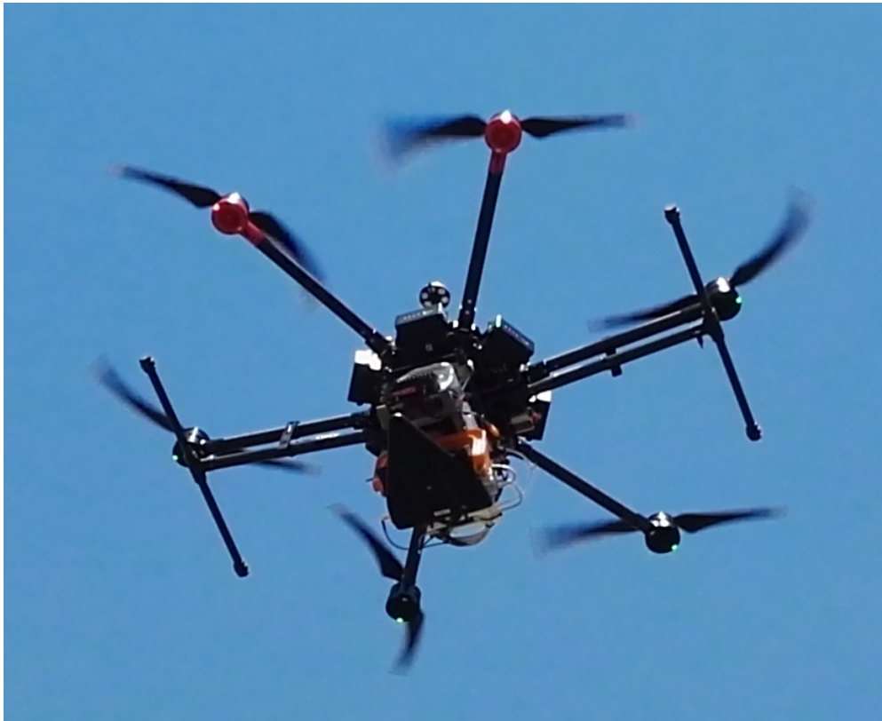
Figura 15: Drone DJI Matrice 600 con Payload per rilevamento "Jammer"
