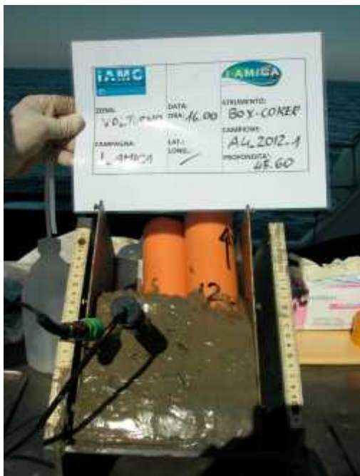
Figura 6 - Misurazione nel sedimento di T°, pH ed Eh e prelievo delle carotine di sedimento per studi paleoclimatici di alta risoluzione
