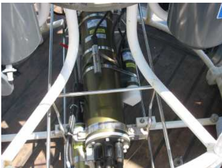
Figura 7 - Sonda multiparametrica Modello SeaBird (SBE 911) installata sulla N/O Astrea.
