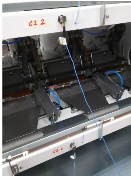
Figura 10. Esempio di punti caratterizzati da maggiore vibrazione
