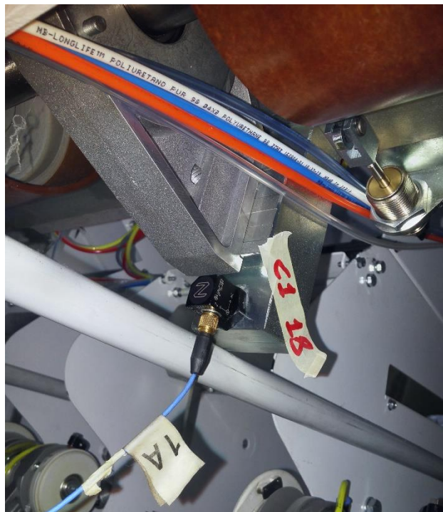
Figura 14. Punto 18 sul lato inferiore del blocco supporto cuscinetto albero di raccolta
