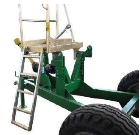
Esempio di scaletta di accesso
