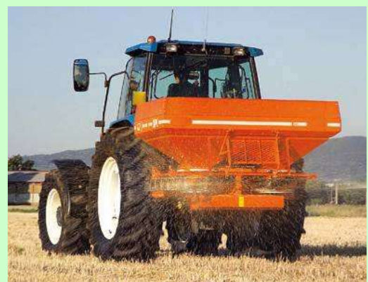
Esempio di spandiconcime portato applicato alla trattrice
