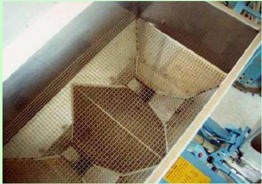
Esempio di griglia di protezione della tramoggia
