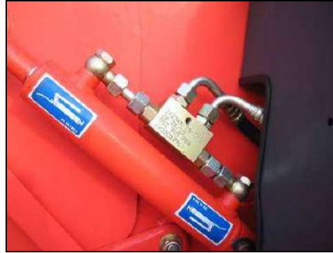
Esempio di valvola di blocco montata sul pistone di apertura testata di scarico
