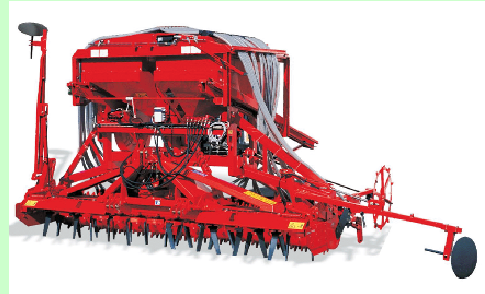
Esempio di seminatrice con dispositivo marcafile ripiegabile e regolabile
