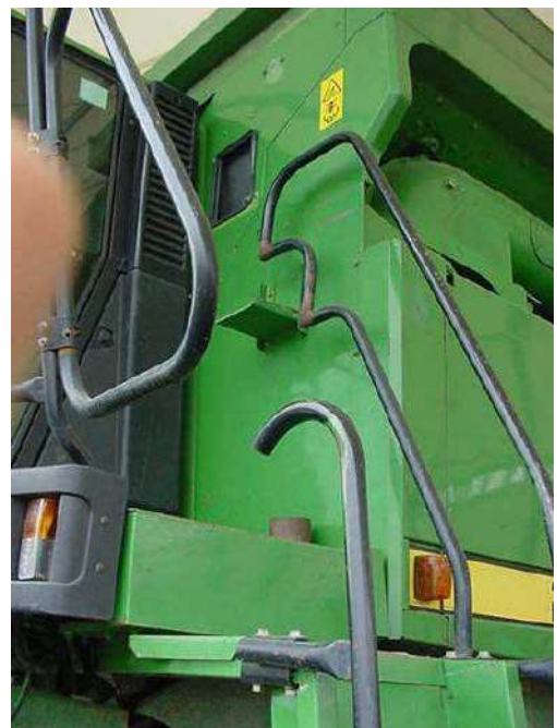
Esempi di scaletta con mancorrenti
