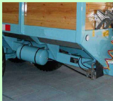
Esempio di protezione contro l'accesso agli elementi mobili sotto il cassone
