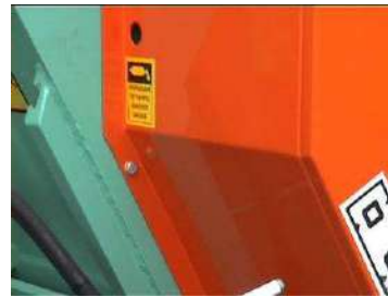
Esempio di riparo chiuso mediante bulloni
