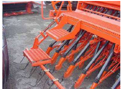
Esempio di scaletta di accesso
