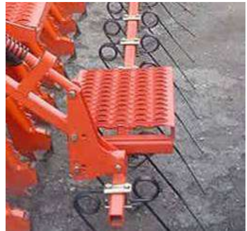
Esempio di superficie antisdrucciolevole
