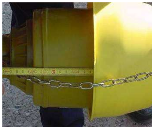
Quota minima di sovrapposizione (UNI EN ISO 4254-1)
