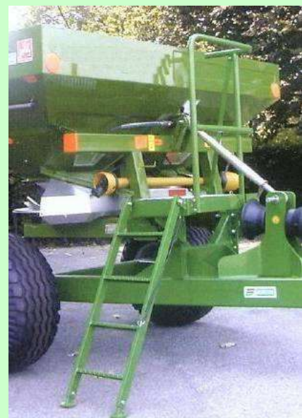
Esempi di mezzi di accesso alla tramoggia
