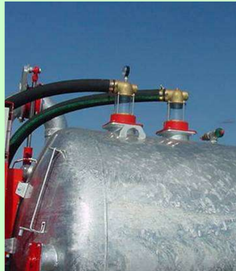
Esempio di dispositivo di troppo pieno
