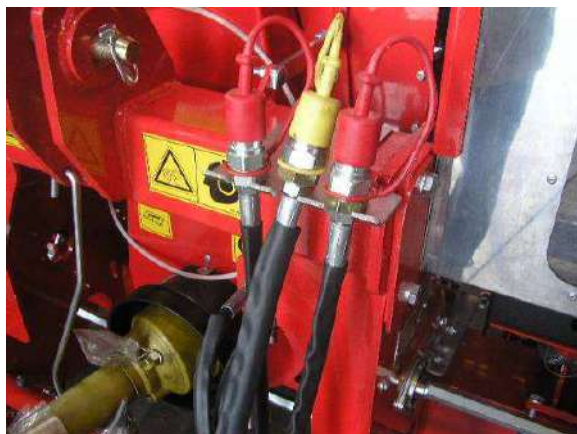
Esempio di tubi idraulici protetti e supportati
