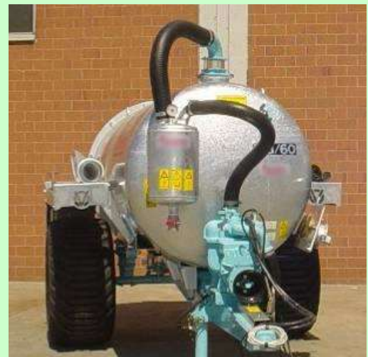
Esempio di supporto tubi flessibili al serbatoio
