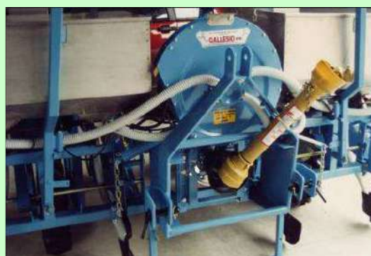
Esempio di zona di accoppiamento alla trattrice della seminatrice
