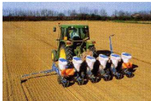
Esempio di seminatrice di precisione semiportata
