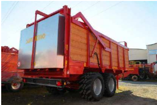
Esempio di organi spanditori con protezione contro il contatto involontario
