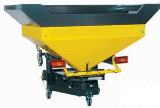
Esempio di spandiconcime portato
