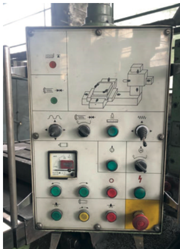
Figura 7 – Esempio di interfaccia operatore - dispositivi di comando (fonte UCIMU - Sistemi per produrre)
