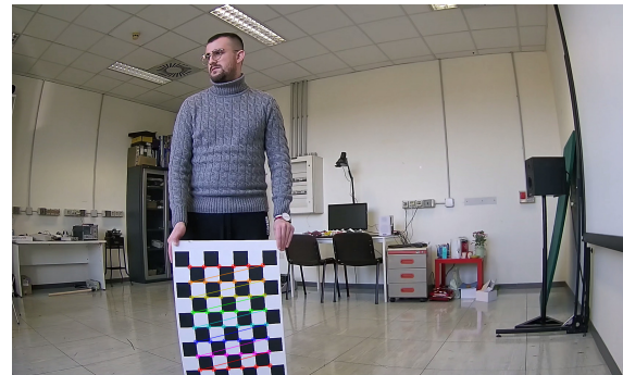
Figura 2.7: Immagine non ancora sottoposta ad undistorsion però con riconoscimento del pattern della scacchiera, passaggio necessario per calcolare i coefficiente di distorsione
