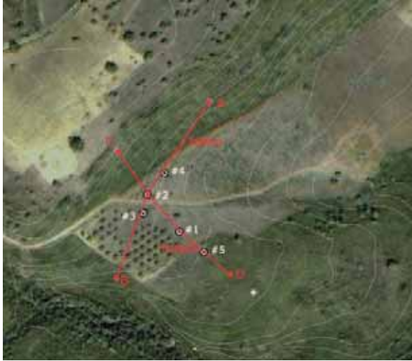
Fig. 4 - Traccia dei due profili tomografici (Tomo-1 e Tomo-2), effettuati a Piano dell'Acqua (indagini risalenti all'agosto 2009). Sono indicate anche le ubicazioni degli sprofondamenti (#1-5).
