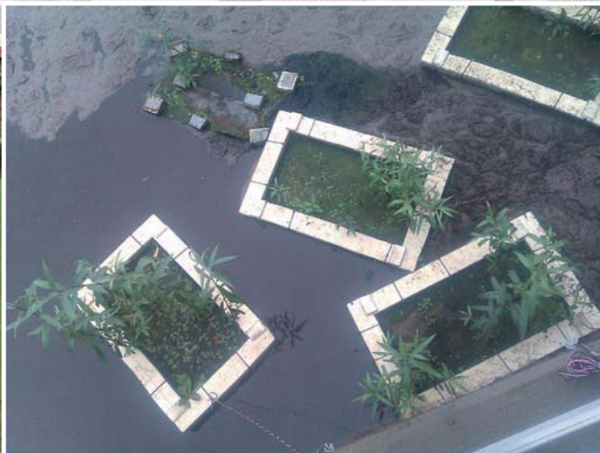
Figura 1 - Celle a combustibile microbiche in sperimentazione in una vasca di depurazione dell'impianto Milano-Nosedo.
