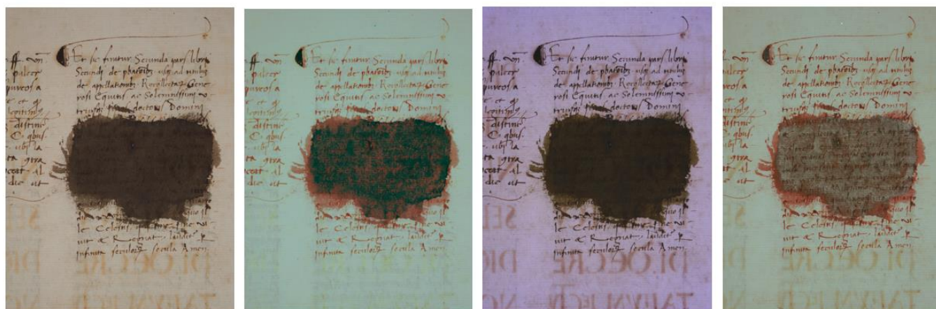
Fig. 4 a) Visibile b) Infrarosso Falso colore (IRFC) c) Ultravioletto Falso Colore (UVFC) d) COMPOSITE 01
