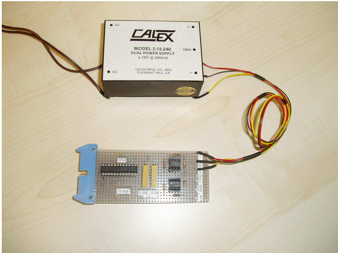
Foto 6 - 7. Fronte retro circuito convertitore A/D
