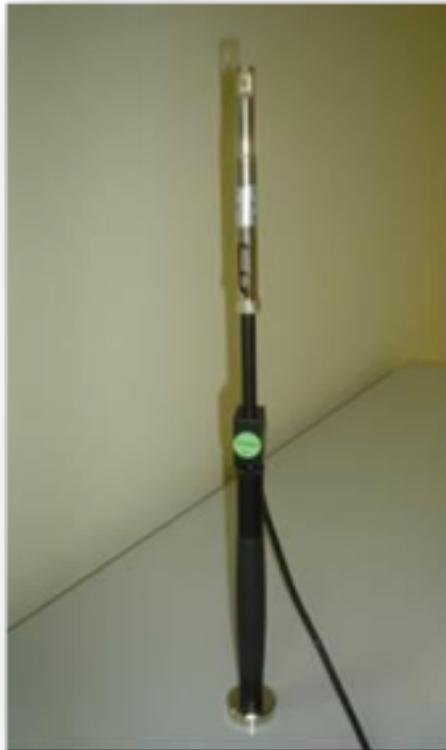
**Figura 37: sonda anemometrica**
