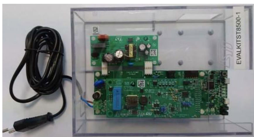
Figura 33 Modulatore effettuato per la modulazione di segnali PLC.
