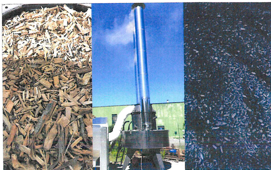
Immagine schematica del processo di produzione di biochar attraverso il prototipo realizzato nell'ambito del progetto CARTER: dal cippato (a sinistra) al biochar (a destra).
