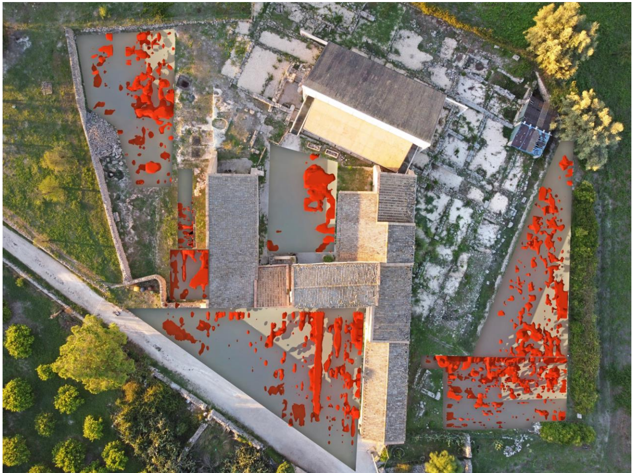
Fig. 25. sovrapposizione delle anomalie individuate sulla foto da drone
