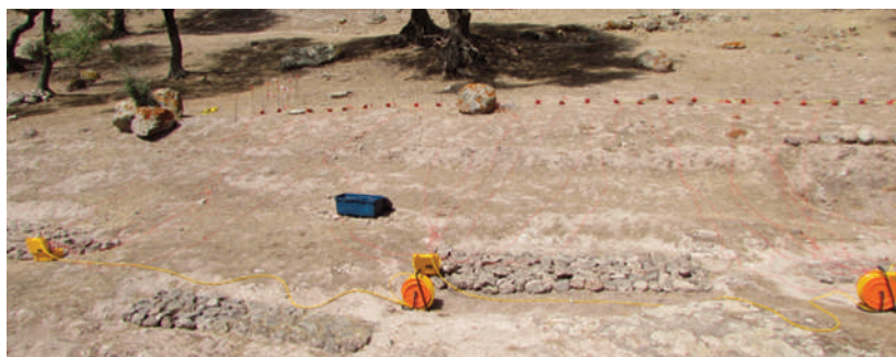
7. PARTICOLARE DI UNO STENDIMENTO GEOELETTICO CON 64 ELETTRODI (foto di S. Trastu)
