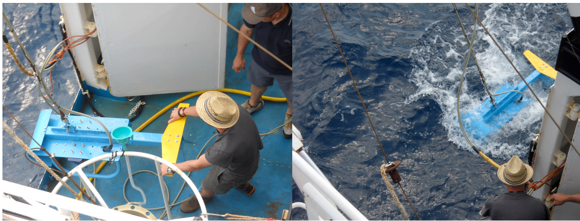
Figura 3: Posizionamento del tow body in mare durante le fasi di cala.
