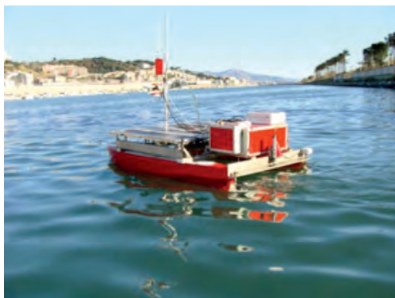
Veicolo marino senza equipaggio utilizzato nella verifica sperimentale del metodo di identificazione proposto - Catamarano di superficie senza equipaggio Charlie.
