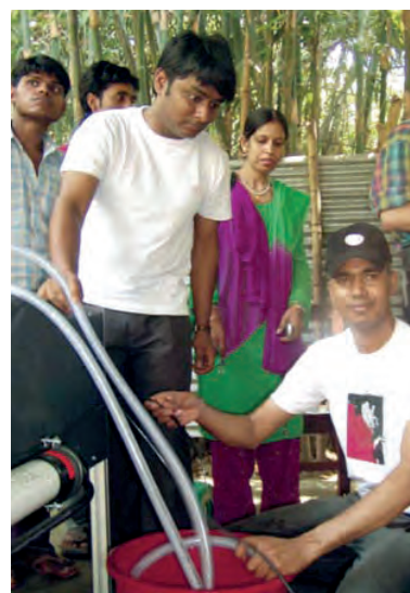
Test su campo per la rimozione di arsenico mediante nanofiltrazione in Bangladesh.
