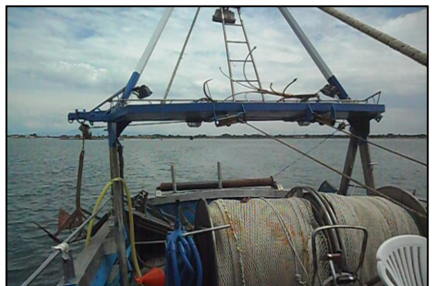
Figura 8. Fase dell'acquisizione. Una volta calata in mare la prima ancora, il peschereccio, filando in mare il cavo d'acciaio, si muove verso il secondo punto dello stendimento per calare la seconda ancora.
