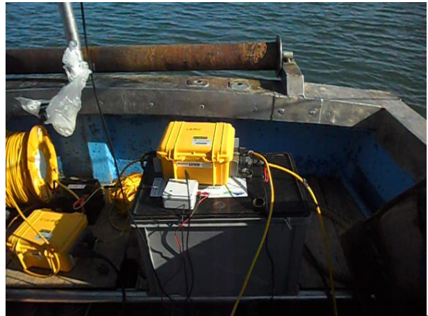
Figura 2. Sistema di acquisizione dati costituito da sismografi Geode.
