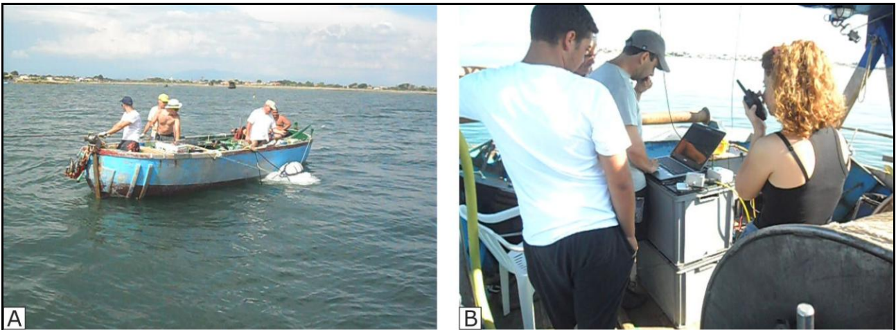
Figura 12. Acquisizione linea sismica. (A) Assicurati alla “linea di fede” si procede con l’energizzazione. (B) Controllo e registrazione dei dati.
