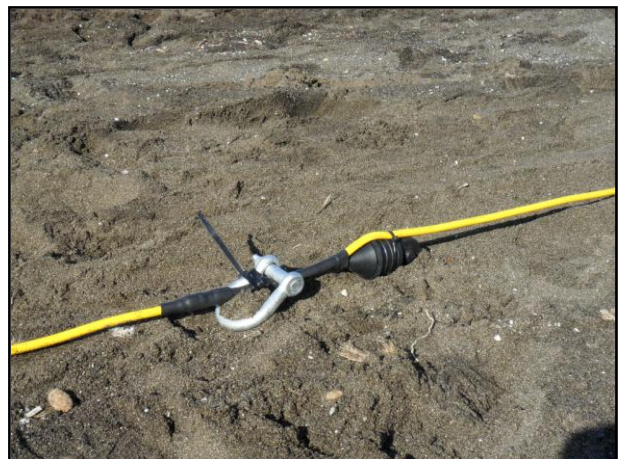
Figura 3. Idrofono. Al cavo sismico (in giallo) sono stati legati, in corrispondenza di ogni idrofono, dei maniglioni di 300 g. per meglio favorirne la discesa in profondità.
