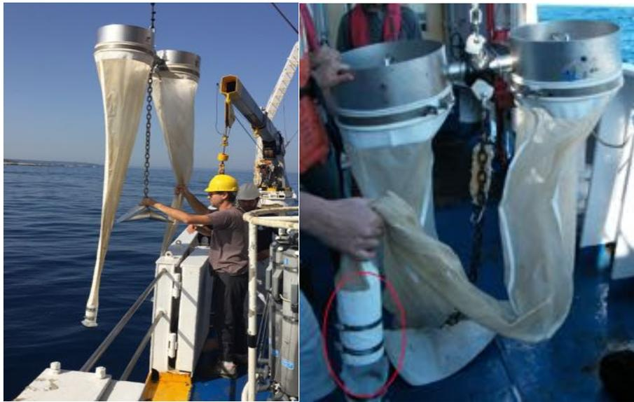
*Figura 2: Strumento campionatore ittioplanctonico Bongo 40.*
