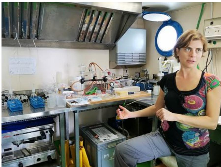
*Figura 15: Apparato di filtrazione dei campioni per la determinazione delle TEP in acqua di mare*
