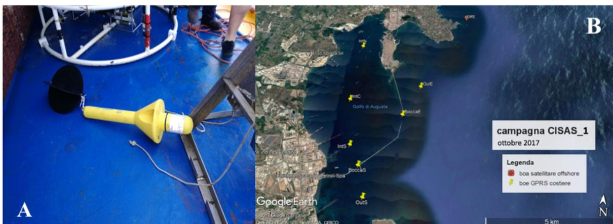
Figura 8: Drifter (A), Punti di rilascio Drifter (B)
