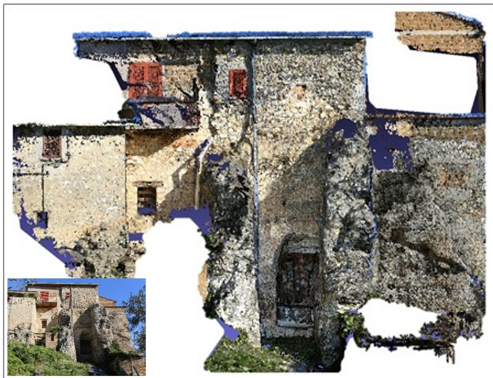
Fig. 4. Cantalupo, località San Vito, modello per nuvola di punti, in basso a sinistra immagine del prospetto ricostruito.
