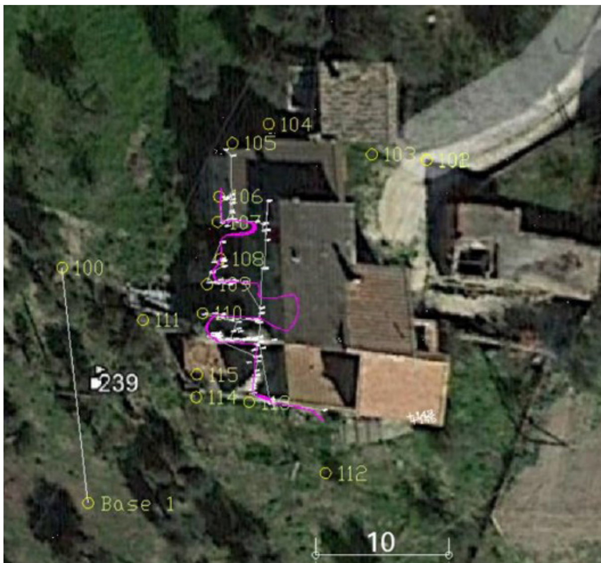
Fig. 3. Cantalupo, località San Vito, planimetria delle stazioni e dei punti rilevati.
