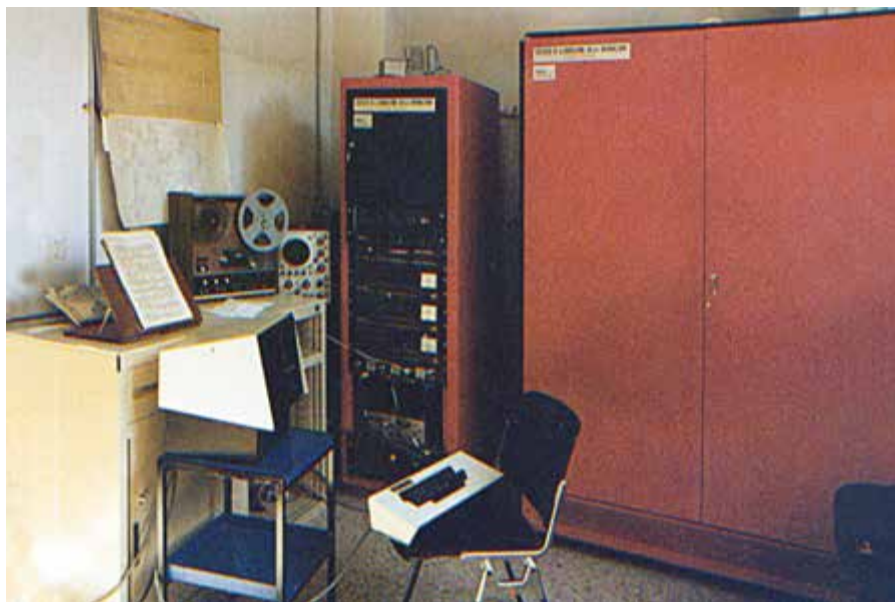
Vista d'assieme del TAU2: a sinistra il posto di lavoro utente, il rack dell'Unità Digitale, con gli apparati di mixaggio e amplificazione e a destra l'Unità Audio.
