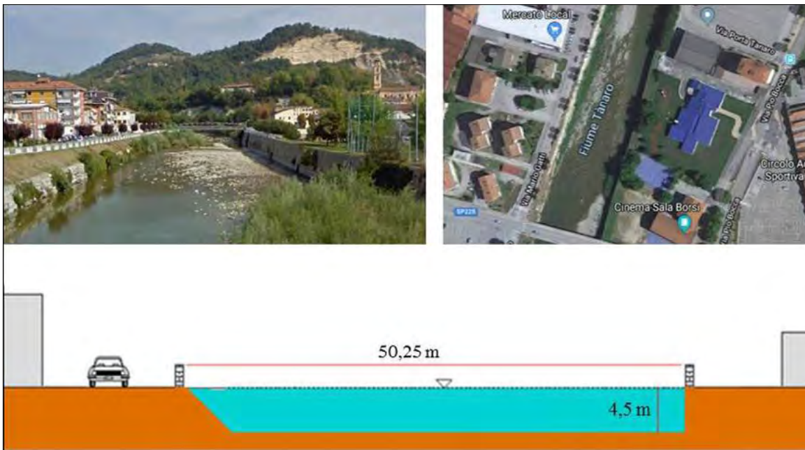
Figura 9. Ubicazione e schema semplificato della sezione T2, immediatamente a valle del ponte della SP225 e a monte della scuola materna di Ceva
