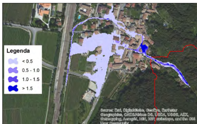
Figura 6. (sx) Tavola dei tiranti massimi espressi in metri (evento con tempo di ritorno pari a 100 anni). Figura 7. (dx) Tavola dell'area di attenzione ottenuta dalla modellazione
