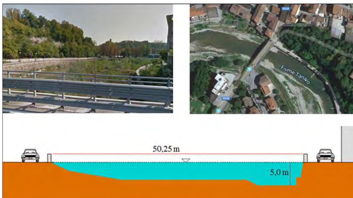
Figura 8. Ubicazione e schema semplificato della sezione T2, immediatamente a monte del Ponte Battaglione Ceva.
