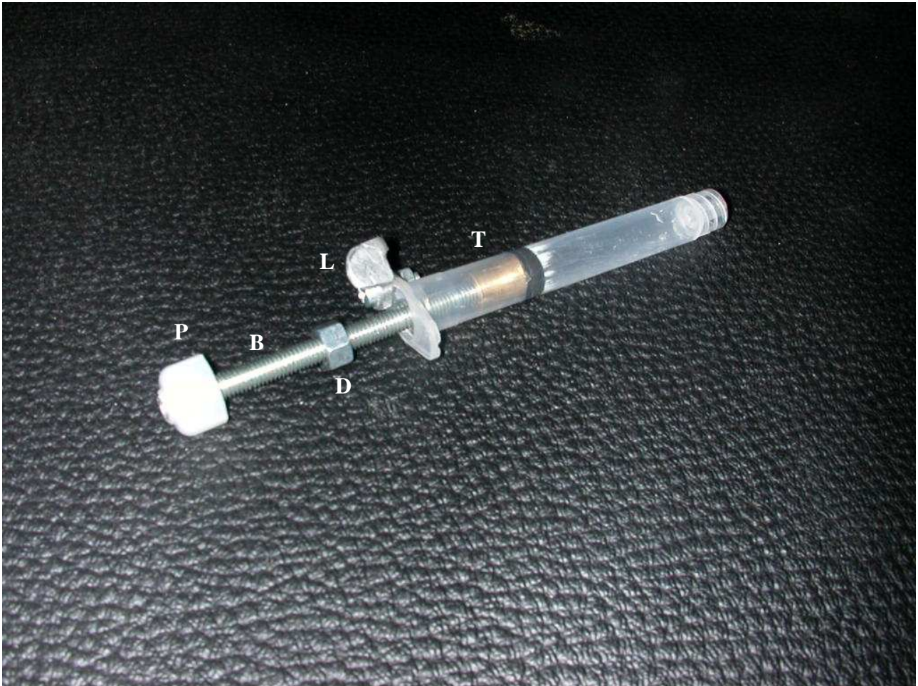
Figura 7. Regolatore di pressione nello stato di caricamento (vedi testo).
