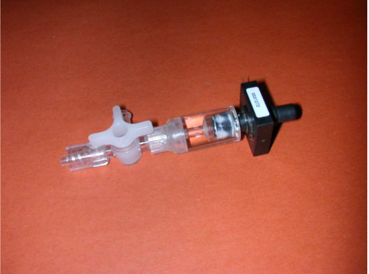
Figura 9. Trasduttore di pressione con adattatore per il raccordo ad un rubinetto a 4 vie.
