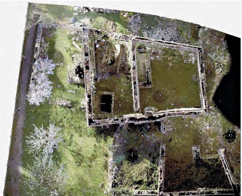
Fig. 3 Planimetria del cosiddetto Palazzo del Doge: sovrapposizione delle immagini fotografiche alla nuvola di punti acquisita con laser scanner (da CARDACI, VERSACI 2013, 87).
