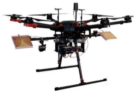
Figure 3. Picture of UAV GPR System 9. Courtesy of Deutsches Zentrum für Luft- und Raumfahrt (DLR), Germany.
