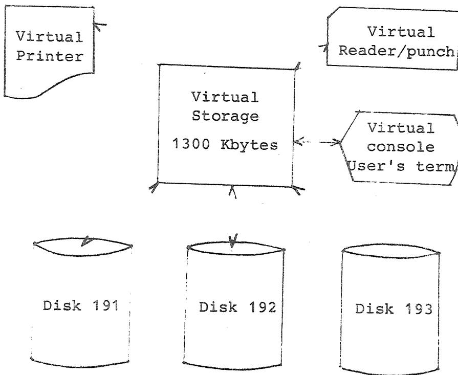
Fig. 2 - SIRDUE Virtual Machine
