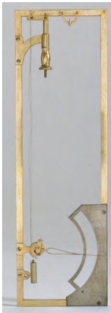
Fig. 2 - Igrometro a capelli di H. B. de Saussure, conservato al Museo Galileo di Firenze. Riproduzione su concessione del Museo Galileo, Firenze - Archivio Fotografico.
