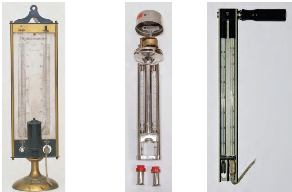
Fig. 4 - Psicrometro di E.F. August esposto al Museo Galileo, di Firenze (riproduzione su concessione del Museo Galileo, Firenze, Archivio Fotografico), a sinistra, psicrometro aspirato meccanicamente di R. Assmann (foto di G. Fasano), al centro, e psicrometro a fionda (foto di G. Fasano), a destra.
