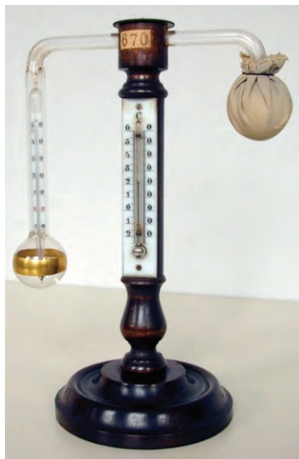
Fig. 3 - Igrometro a condensazione di J.F. Daniell, esemplare di fine '800 conservato al Museo dell'Innovazione e della Tecnica Industriale di Fermo (Foto di C. Profumieri), a sinistra, ed esemplare di igrometro a condensazione o ad appannamento di H.-V Régnault conservato presso il Gabinetto di Fisica del Museo urbinato della Scienza e della Tecnica dell'Università di Urbino (Mantovani, 2010), a destra: A: aspiratore metallico, P: piede di ottone, C1 e C2: provette metalliche, R: tubo di raccordo, T1 e T2: termometri.
