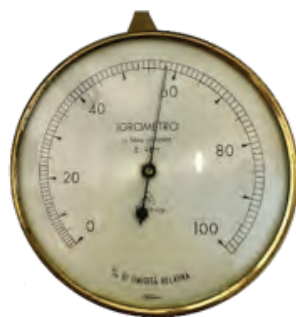
Fig. 5 - Igrometro a capelli della seconda metà del Novecento. In questo strumento la sostanza igroscopica è un fascio di fibre sintetiche (foto di G. Fasano)
