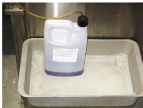
Рис. 3.2. Пример правильного хранения оттока подвижной фазы из ВЭЖХ
