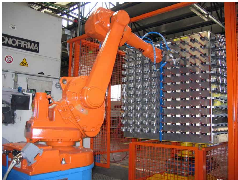
Isola robotizzata per l'alimentazione tramite un robot antropomorfo, recentemente realizzata dalla Hydros Snc
