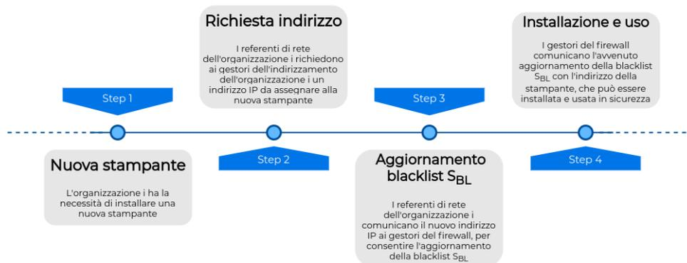
Figura 2: procedimento per la corretta installazione di una nuova stampante, ovvero l’aggiunta di un nuovo indirizzo alla blacklist  $S_{BL}$
