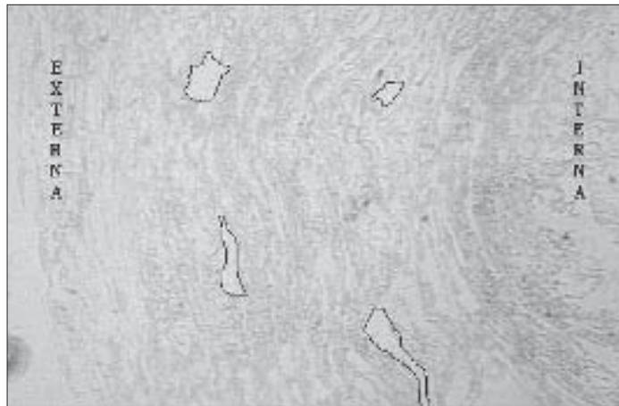
Figura 2. Estructura de la superficie de las prótesis PU-PDMS vista por microscopía óptica. Destacan las dimensiones de los poros (marcados con una línea) ( \times 10 ).
