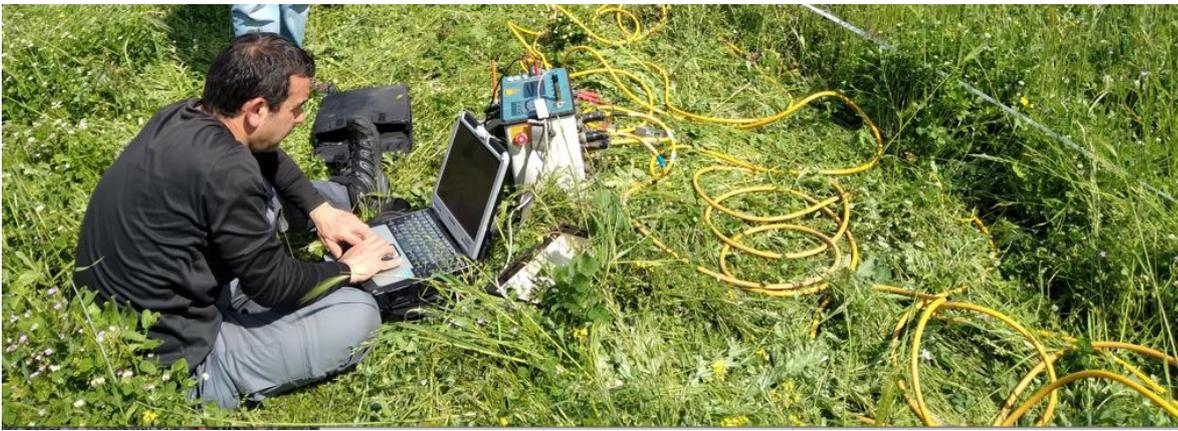
**Fig. 4: strumentazione geoelettrica.**
