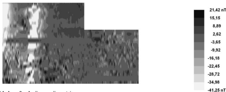
Fig. 15: aree 2 e 4: Modello di distribuzione del gradiente magnetico.
