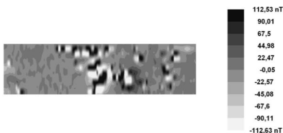
Fig. 16: area 5: Modello di distribuzione del gradiente magnetico.
