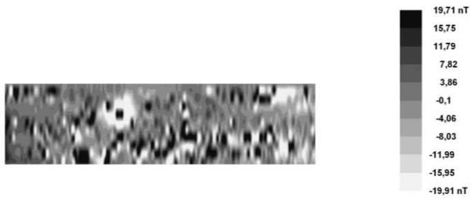
Fig. 17: area 6: Modello di distribuzione del gradiente magnetico.
