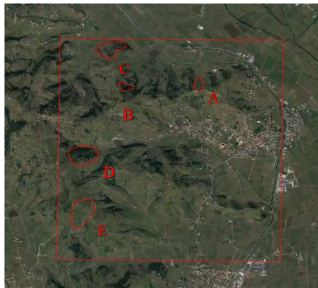
Fig.3.1.5: zone con probabili dissesti individuate tramite foto aeree in QGIS.
