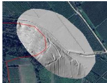
Fig.4.2.15: hillshade della zona C prodotto a partire dal DSM da LiDAR. QGIS.
