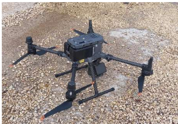
Fig.3.5.1: LiDAR Zenmuse L2 montato sul drone MATRICE 350 RTK.
