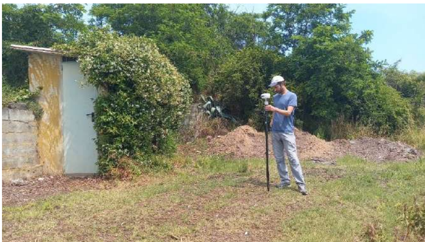
Fig.3.4.1: acquisizione di un punto con il GPS RTK pFCAD ONE - SERIE K.
