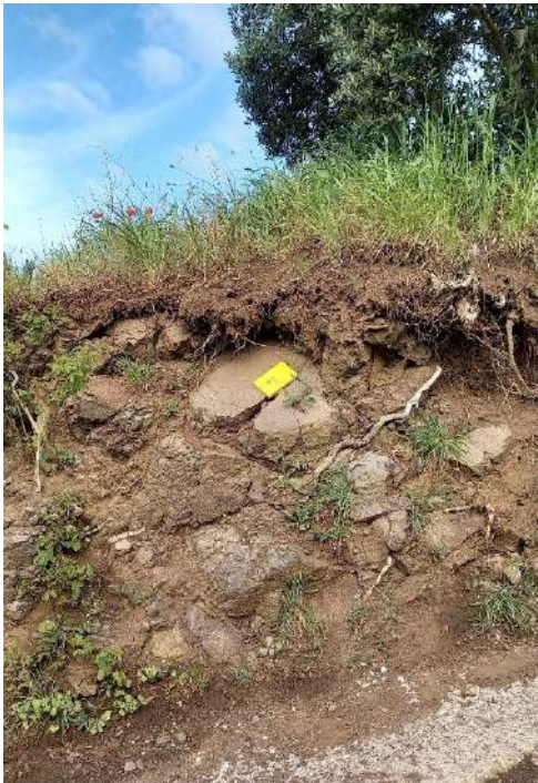
Fig.3.2.19: affioramento di vulcaniti basiche subaeree molto alterate.
