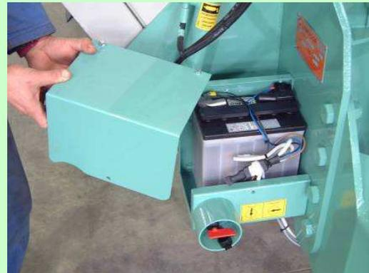
Esempio di alloggiamento della batteria
