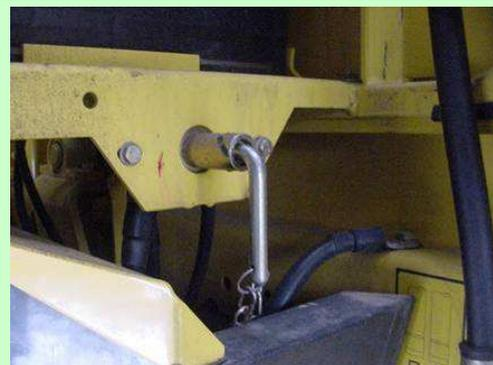
Esempio di dispositivo stacca-batteria
