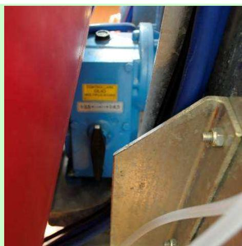
*Esempio di leva di comando del ventilatore*
