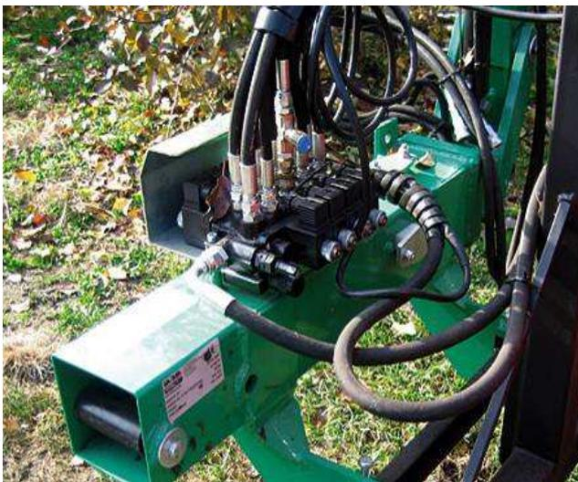
*Esempio di attacchi idraulici*
