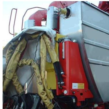
*Esempio di tubi idraulici dotati di guaina antiscoppio*
