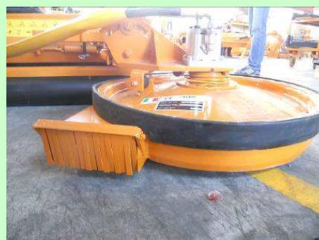
*Esempio di protezione della lama di taglio*
