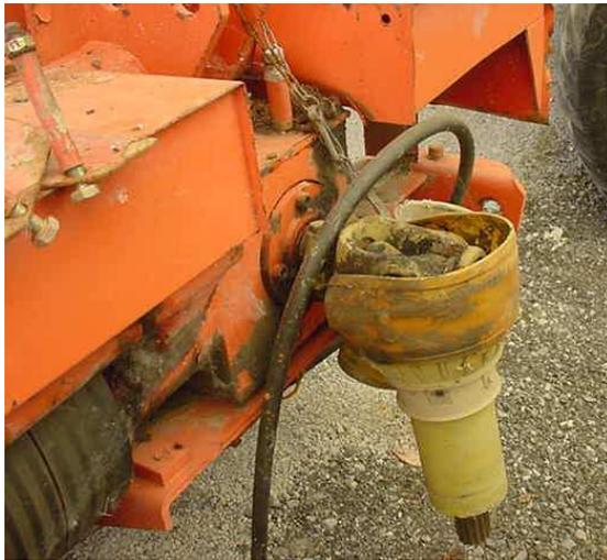
*Esempio di trasmissione cardanica non protetta*
