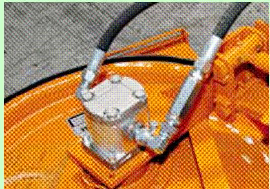
*Esempio di motore idraulico*
