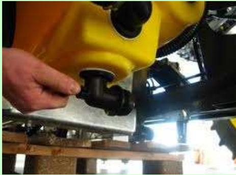
*Esempio di rubinetto di svuotamento del serbatoio*
