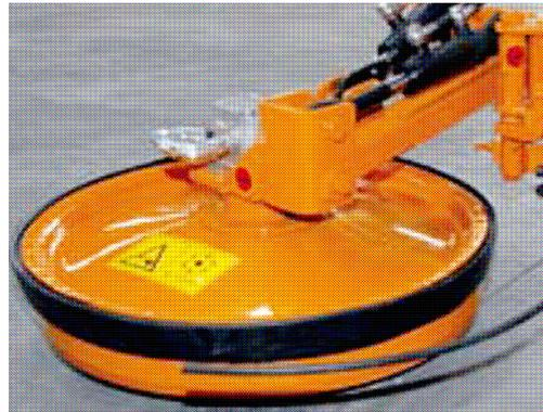
*Rientro idraulico con tastatore*
