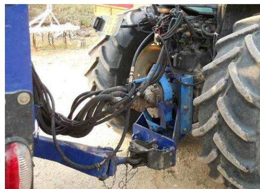
*Esempio di pompa idraulica calettata direttamente sulla presa di potenza*
