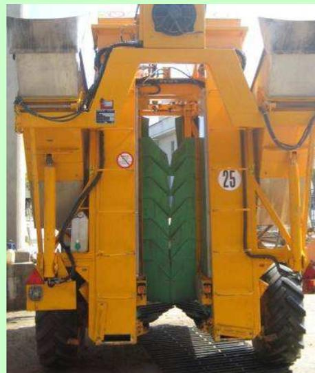
*Esempio di protezioni all'imbocco del tunnel*
