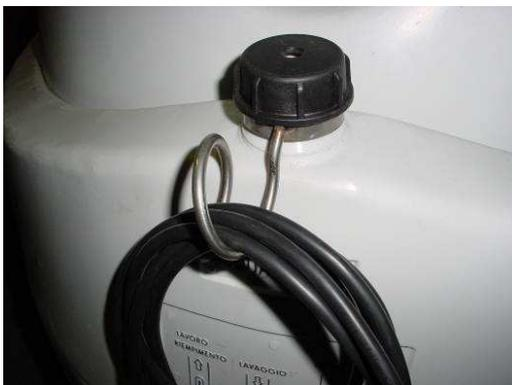
*Esempio di supporto per il cavo elettrico*
