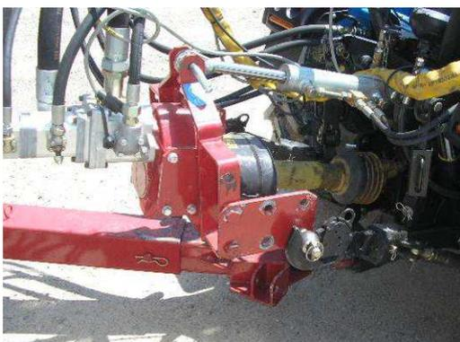
*Esempio di trasmissione cardanica*
