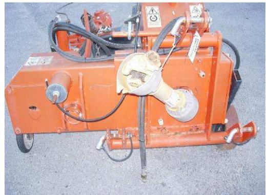
*Esempio di disco interfilare azionato a cardano*
