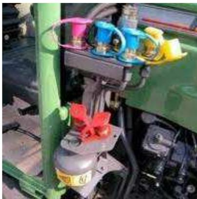
*Esempio di collegamenti idraulici identificabili mediante codice colori*
