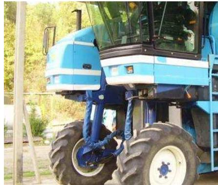
*Esempi di linee idrauliche con guaine antiscoppio*
