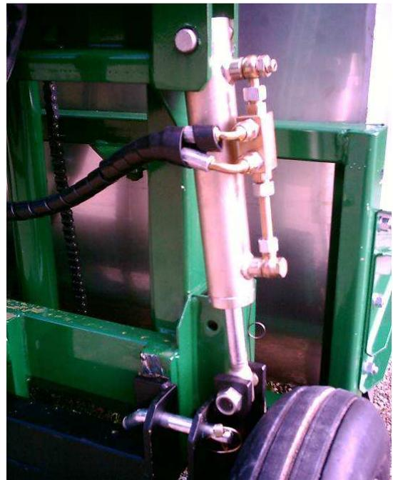
*Esempio di dispositivo di bloccaggio idraulico*
