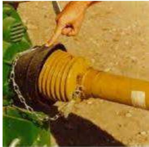
*Esempio di trasmissione cardanica protetta*
