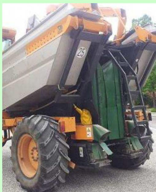
*Esempio di protezioni all'imbocco del tunnel*
