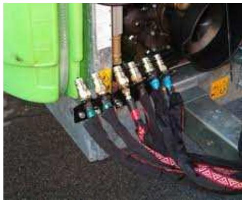
*Esempio di tubazioni idrauliche correttamente supportate*
