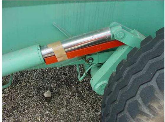
*Esempio di dispositivo di bloccaggio meccanico*
