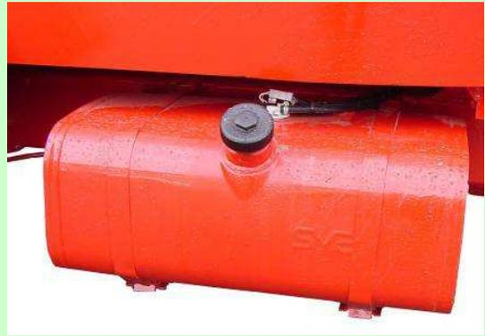
*Esempio di serbatoio carburante*
