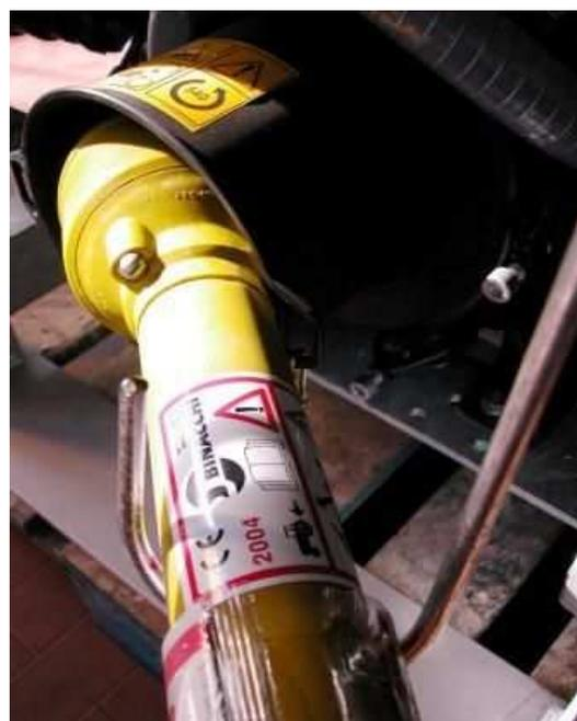
Esempio di trasmissione cardanica protetta e dotata di supporto e pittogrammi
