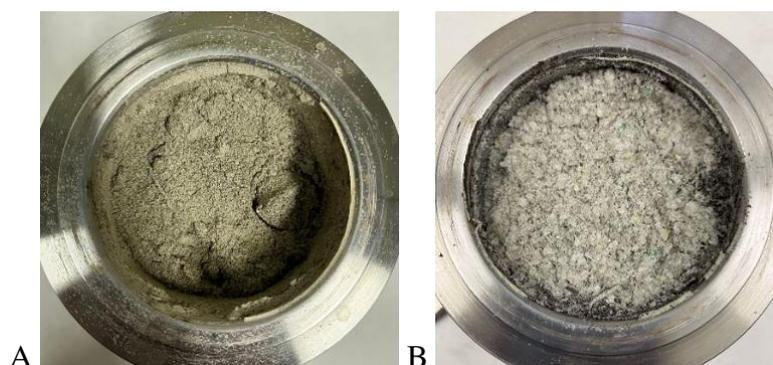
Le polveri sono state miscelate tramite miniestrusore e stampate sotto pressa alle stesse condizioni delle miscele precedenti; successivamente i due film ottenuti sono stati sottoposti a prove di trazione.
