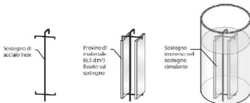
Per le prove di migrazione globale vengono usati i simulanti alimentari, definiti dal Reg CE 10/11 nell'art 3 e dal Reg CE 1416/16. Questi composti hanno la capacità di 'clonare' le medesime caratteristiche dell'alimento che deve venire a contatto con il materiale. Il simulante alimentare è necessario per l'effettuazione di test di migrazione chimica, sull'alimento, e quindi per validare l'utilizzo di un determinato materiale al contatto alimentare.
