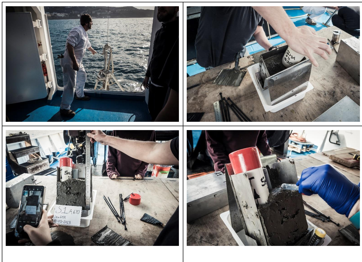
Figura 7 – Fasi di campionamento sedimenti su Box Corer: recupero Box Corer, sub-campionamento con carota per analisi XRF, descrizione e catalogazione campione, prelievo per analisi microbiologiche.
