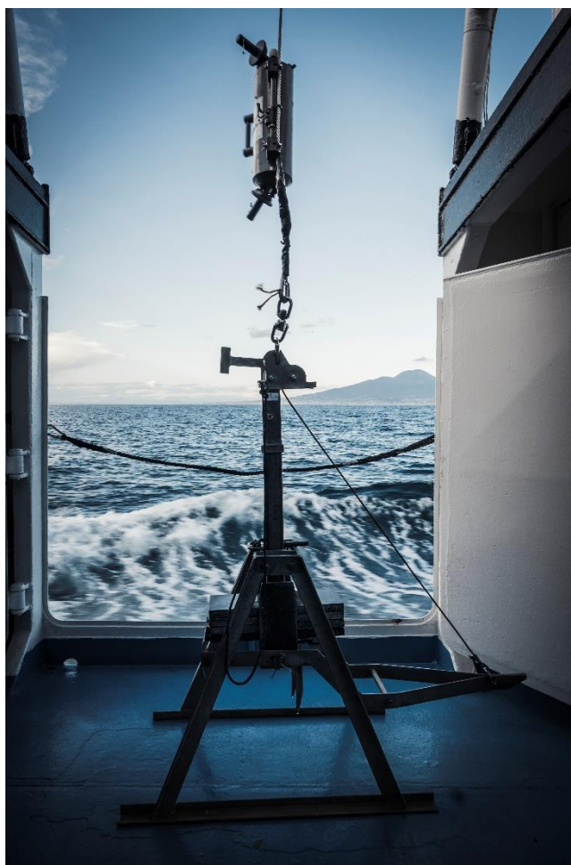
Figura 2 – In navigazione a largo di Napoli, mattino del 9-marzo-2023. Allestimento Box corer + bottiglia Niskin.
