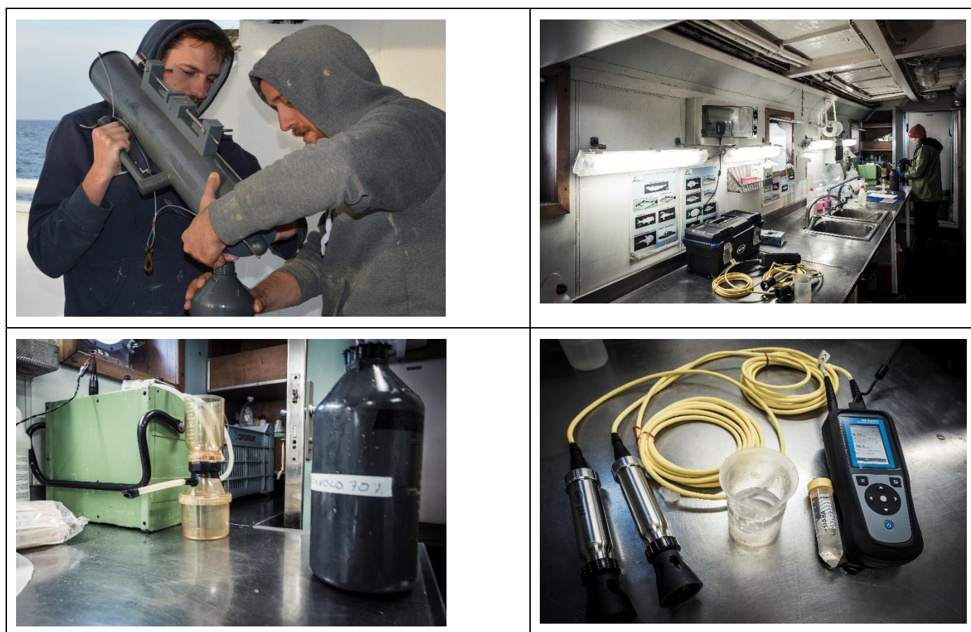
Figura 11 – Fasi di prelievo acqua di fondo: recupero bottiglia Niskin, spillatura acqua da Niskin, misure parametri chimico-fisici acqua, filtraggio acqua per analisi microbiologiche
