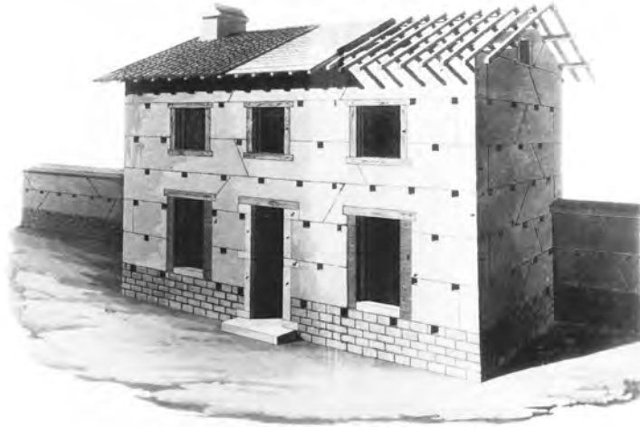
Fig. 3 Constructive features of a rammed earth building. (Rondelet J-B. (1860). Traité théorique et pratique de l'art de bâtir. Paris. Firmin-Didot, tav. V)
