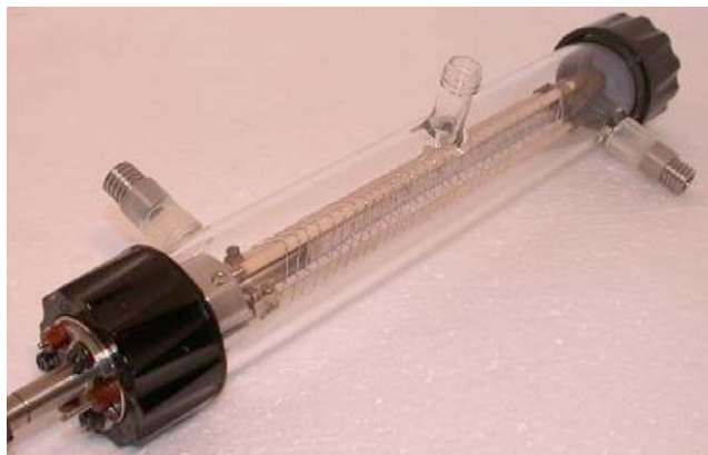
Fig. 2. The membrane module.
