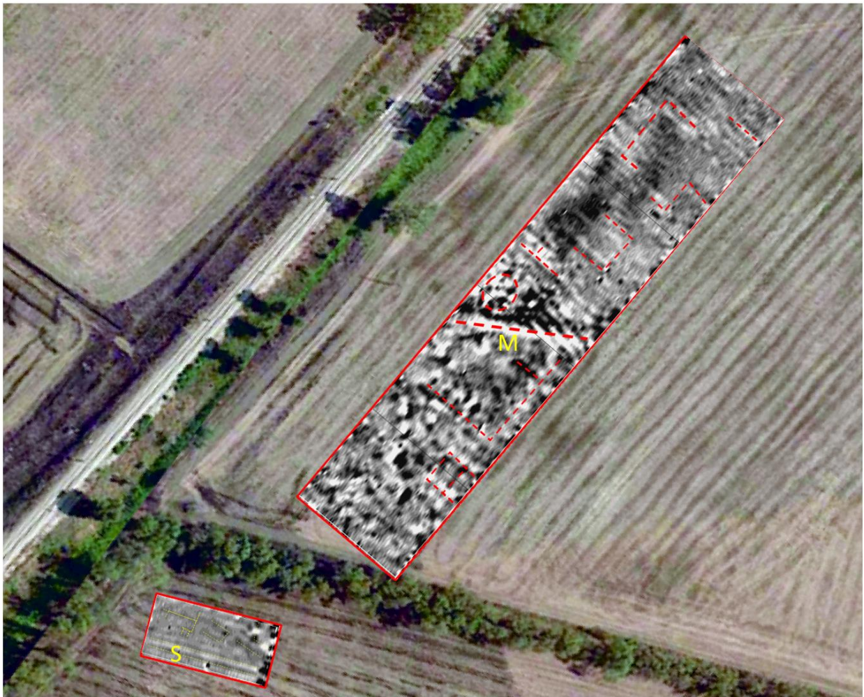
Fig. 5: modello di distribuzione del gradiente magnetico nell'area 1 e 2 sovrapposto all'ortofoto (M: muro; S: strada)
