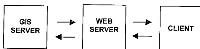
Figura 1.1: Schema di funzionamento generale di Geo-Data Server su Web
