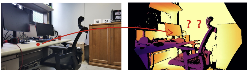
(b) Ambiguità della proiezione inversa da RGB a profondità.
