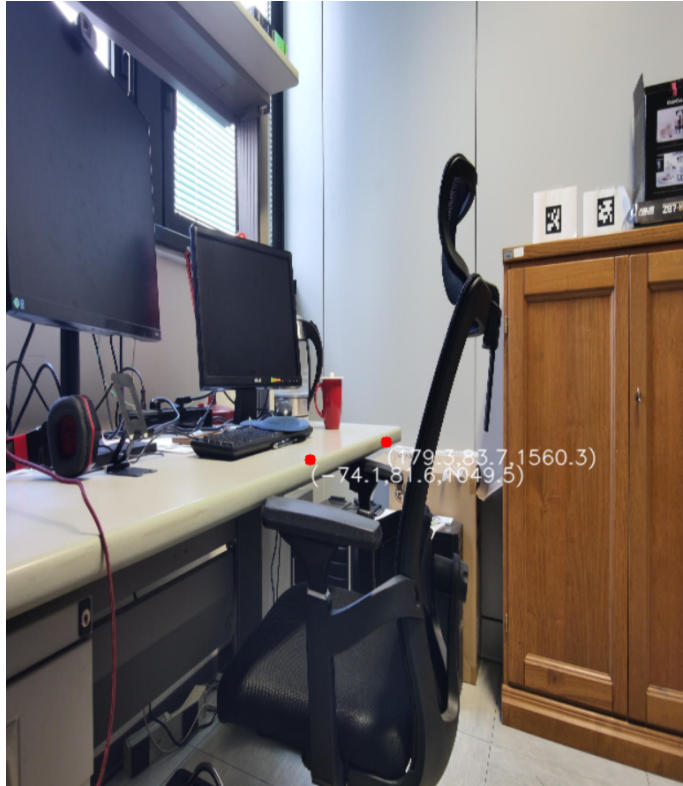
Figura 4.10: Selezionando due punti è possibile ricavare la distanza reale tra i due.
