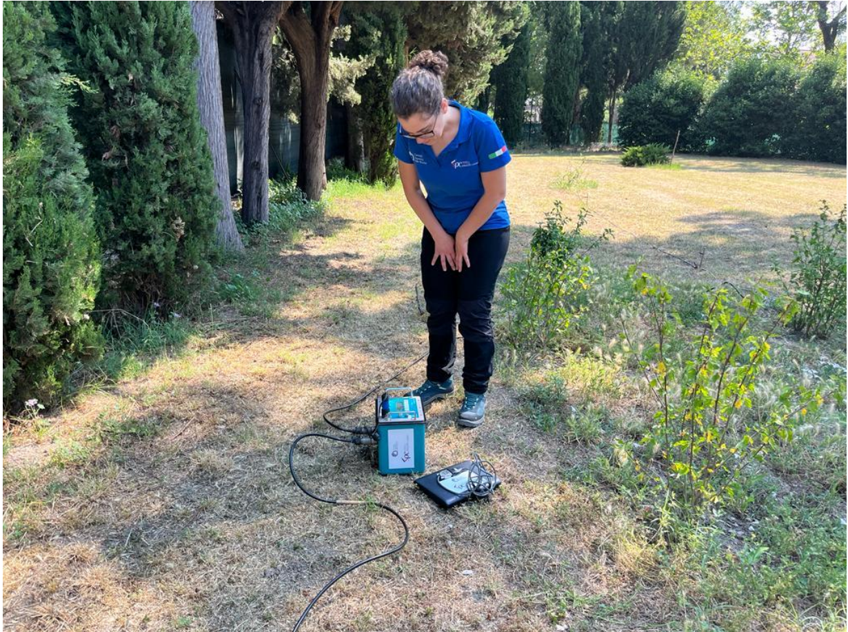
Foto 2: georesistivometro utilizzato nelle indagini
