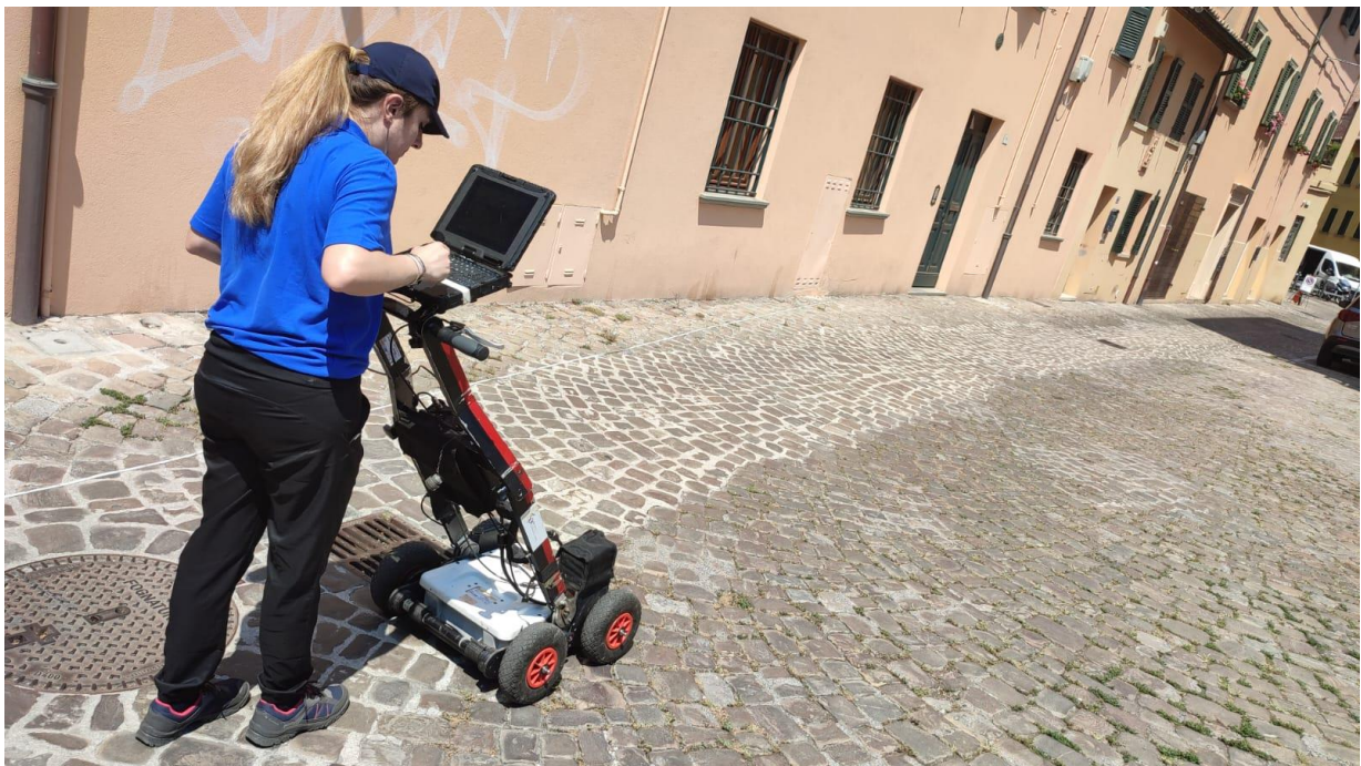
Foto 1: sistema georadar utilizzato nelle indagini
