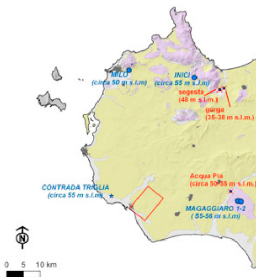
Figura 13. Punti rappresentativi del carico piezometrico nel serbatoio carbonatico e relativi valori tra parentesi (in m s.l.m.)
