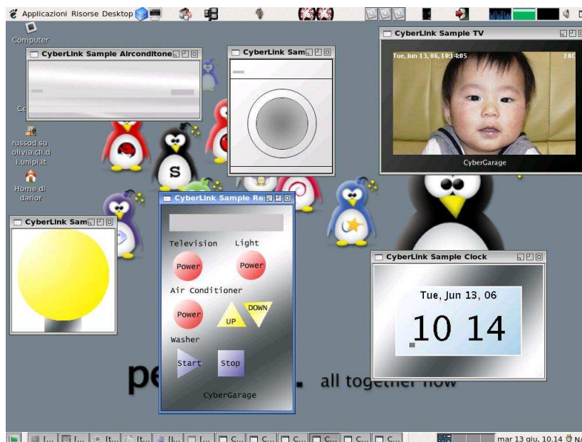
Figura 8.2: I dispositivi domotici UPnP simulati utilizzati.
