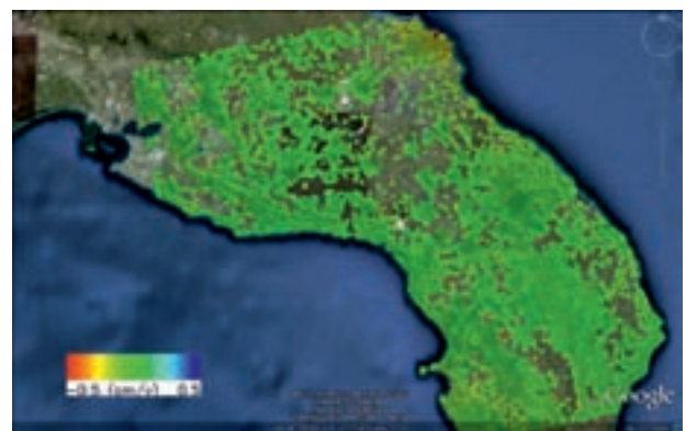
Fig 5 - Mappa di velocità di deformazione a scala regionale relativa all'area del Salento, Puglia meridionale, ottenuta mediante elaborazione di immagini SAR ENVISAT acquisite in orbita ascendente (intervallo temporale: 2003-2010). - Ground deformation velocity map at regional scale relevant to the Salento area, Apulia region (ENVISAT ascending dataset, time interval 2003-2010).
