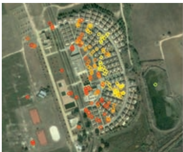
Fig. 8 - Mappa di velocità di deformazione a alta risoluzione relativa ad edifici affetti da subsidenza ubicati a sud della città di Gallipoli (LE), ed esempi di serie storiche di spostamento associate a due punti di misura.
