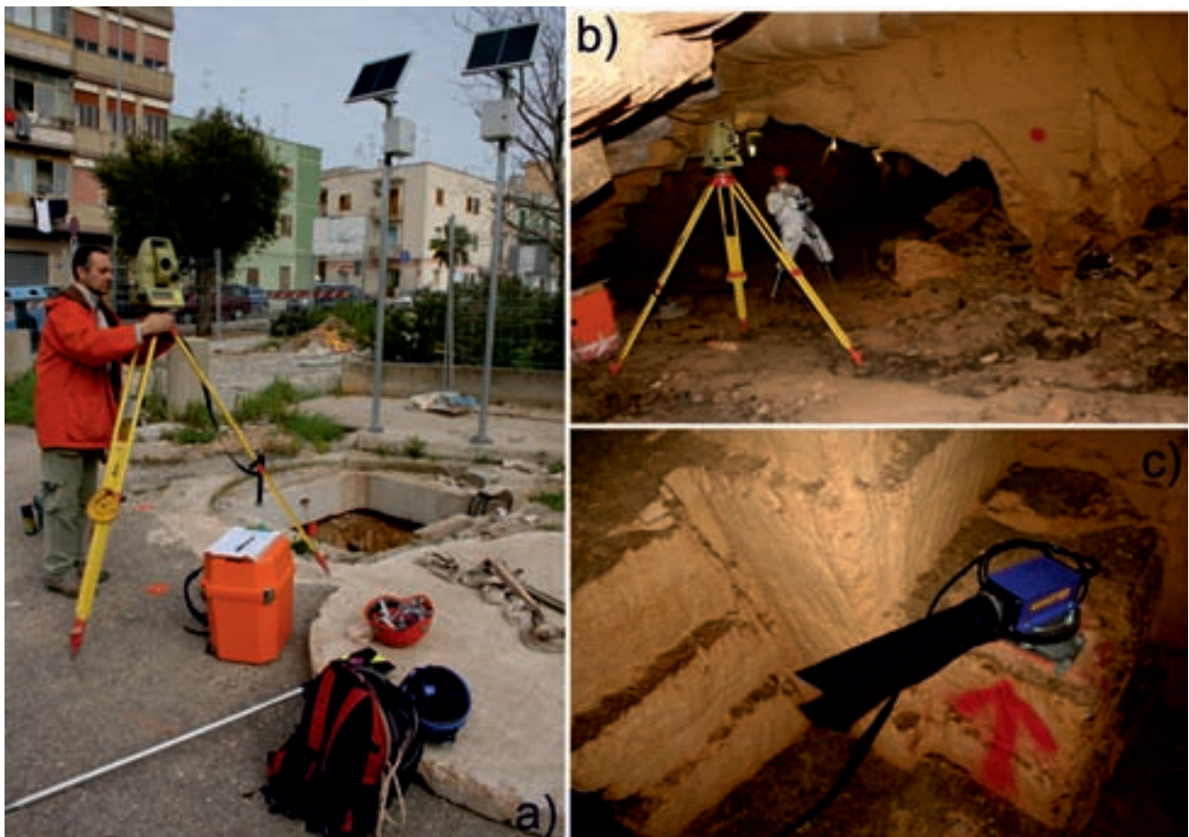
Fig. 4 - Monitoraggio topografico (a) e all'interno di ambienti ipogei (b, c) per la verifica di una eventuale evoluzione dello sprofondamento e delle discontinuità nell'ammasso roccioso.
